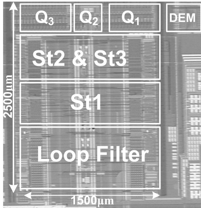
Figure 3.15: The chip die micrograph
