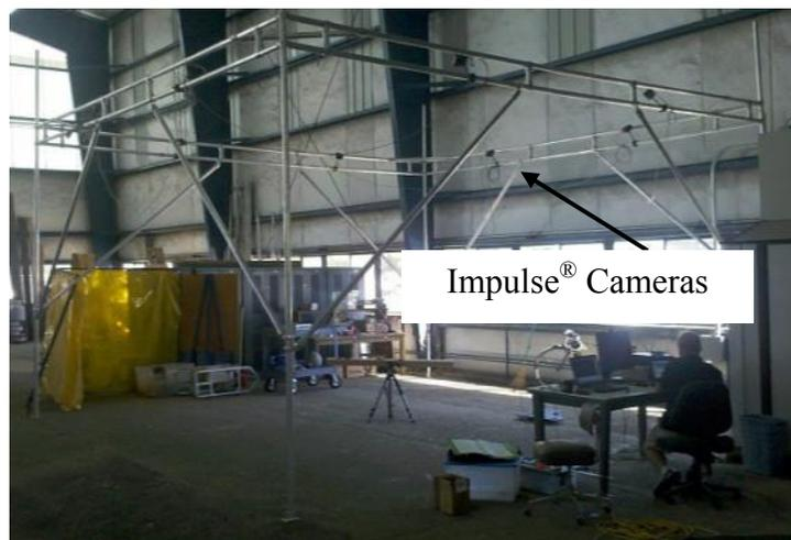
Figure 1: Speed Rail<sup>®</sup> frame and Impulse<sup>®</sup> cameras.
