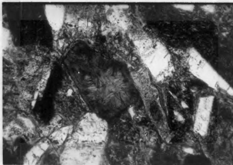
Figure 5. IRON-RICH MONTMORILLONITE-TYPE CLAY MINERAL PSEUDOMORPHOUS AFTER CLINOPYROXENE IN TUFF BRECCIA. 35X, PLAIN LIGHT.
