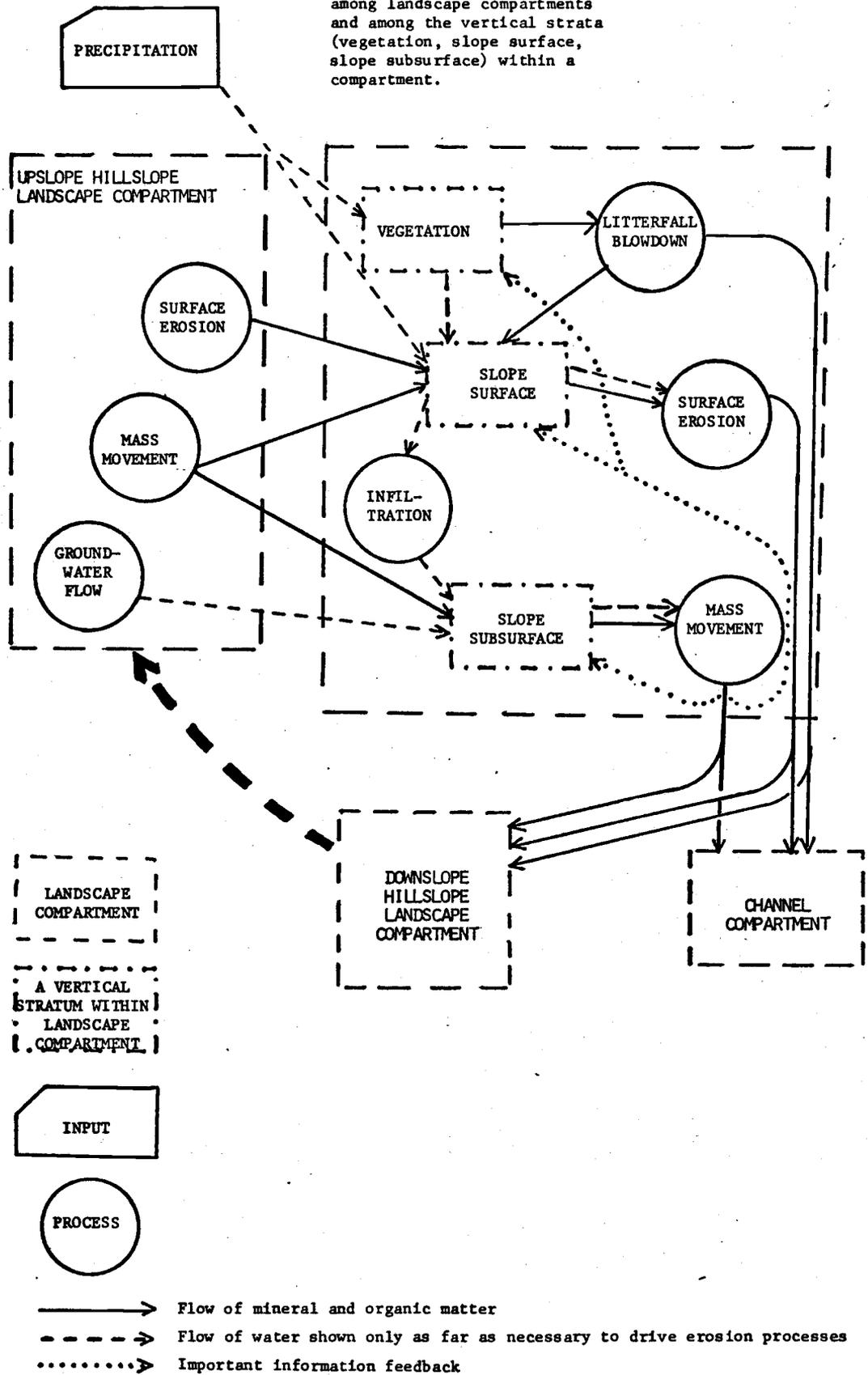
FIG. 2 EROSION MODEL
