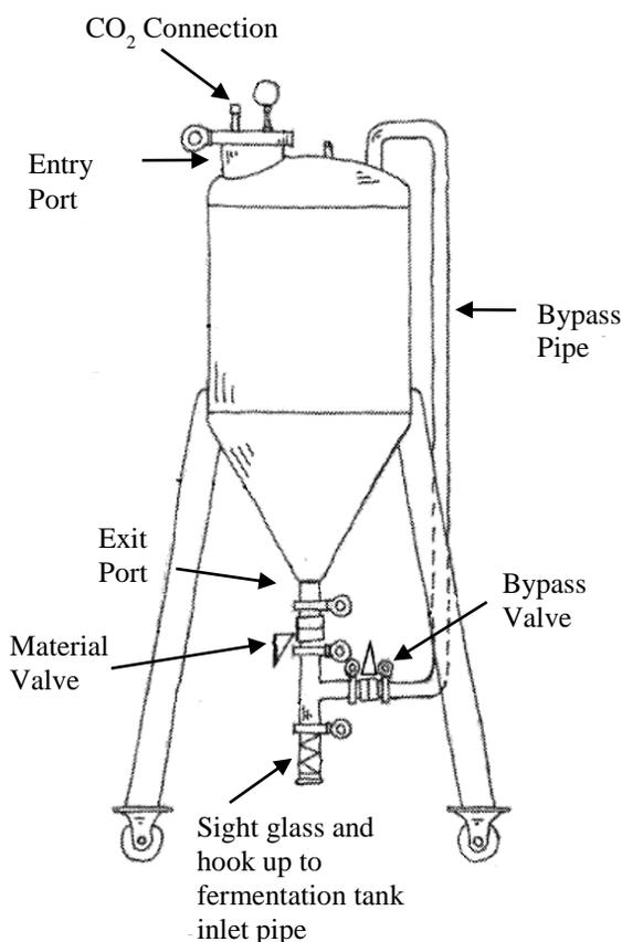
Figure 3. Diagram of a hop cannon. (46)
