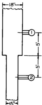
$$- \frac{W_{\text{out}}}{J} = \frac{P_2 v_2}{J} - \frac{P_1 v_1}{J} + \frac{V_2^2 - V_1^2}{2gJ} + \frac{Z_2 - Z_1}{J}$$
