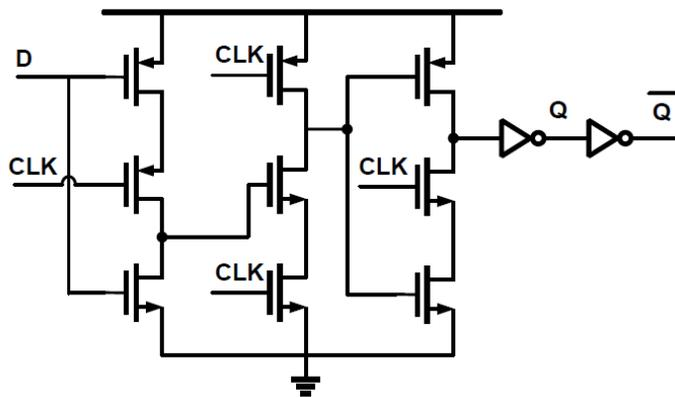
Fig 3.5.2 TSPC Flip-Flop Schematic
