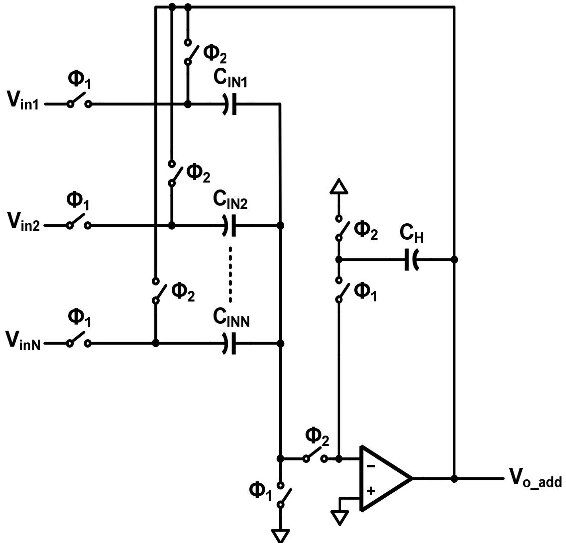
Fig. 2-7. DCT adder.
