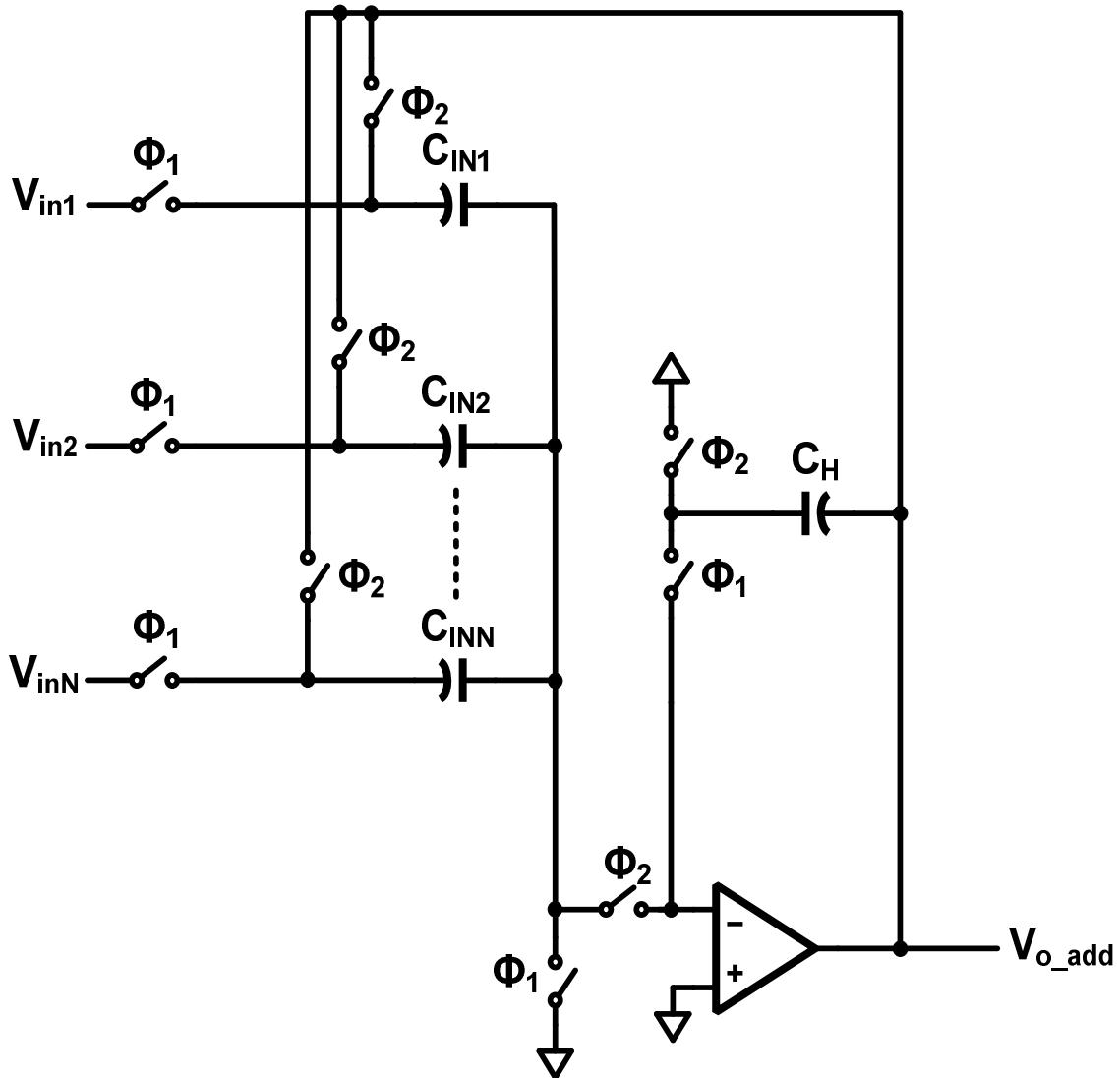
Fig. 2-7. DCT adder.
