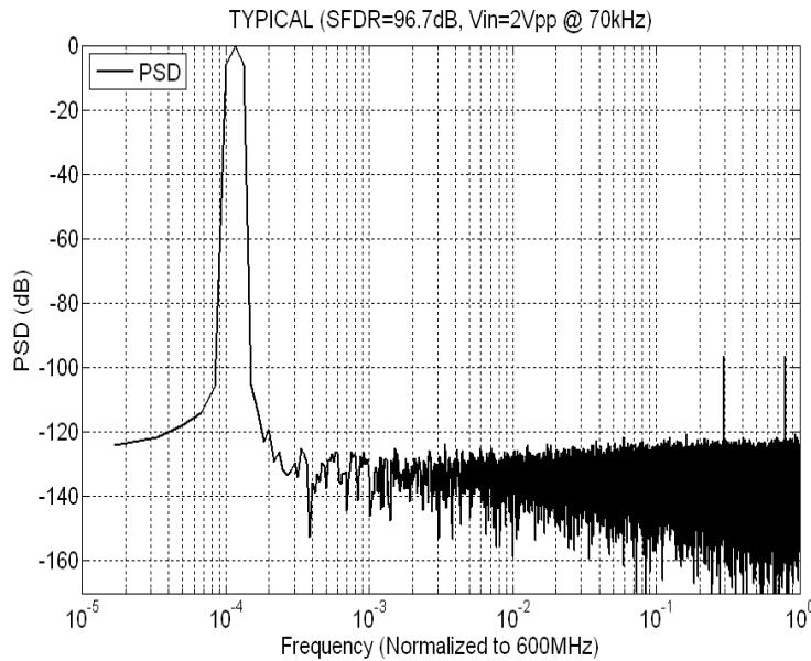
Fig. 6-8. Filter output spectrum.
