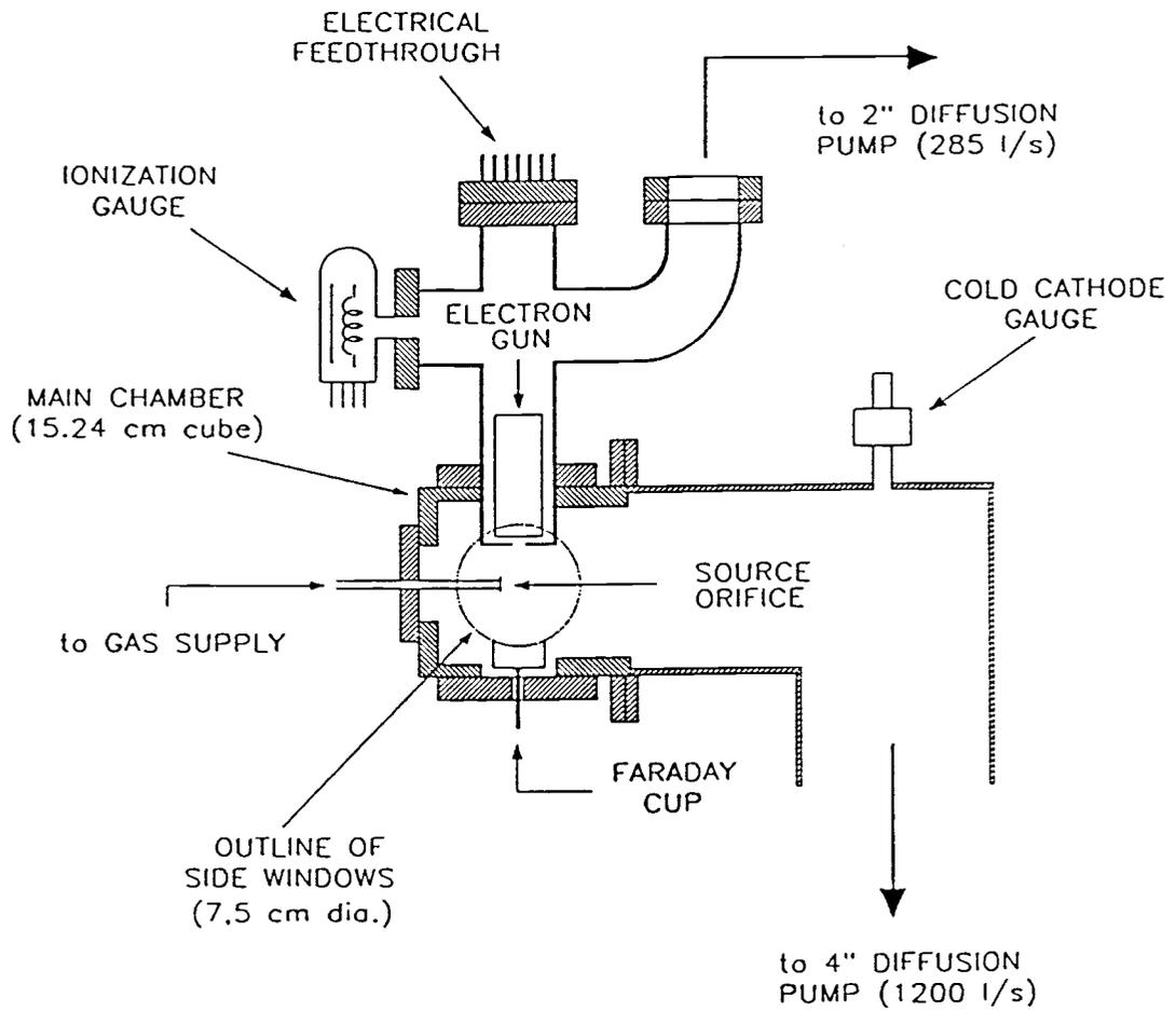
Fig. 2 Diagram of the DSEIF apparatus.
